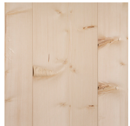
Utslag i och runt kvist. Sprickor i yta.
