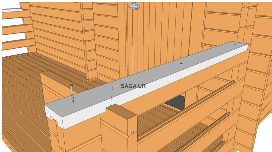
Kapa till de korta bitarna och skruva fast. Stick ut överliggaren ca 35mm in mot altanen.
