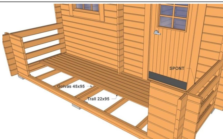
Kapa till och skruva 45x120mm överliggaren till sidoräcket. 15mm utstick på kortändan kan vara lämpligt.
