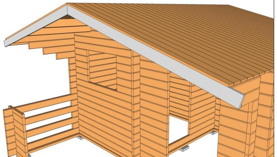
Skruva fast de övre vindbrädorna. Förskjut vindbrädan ca 5cm uppåt.
