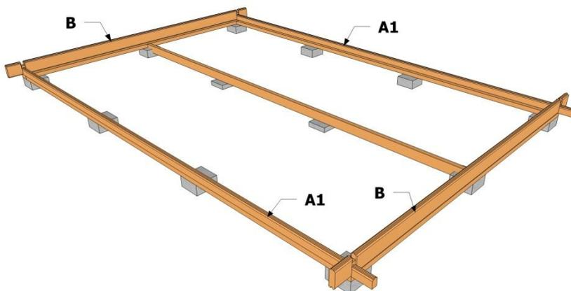
Slå ihop varv efter varv enligt bilden. Använd slägga och medföljande slagklossar. Slå aldrig direkt på en bräda.
