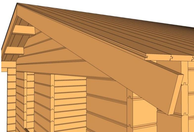
Skruva fast de övre vindbrädorna. Förskjut vindbrädan ca 5cm uppåt.
