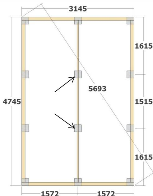
Lägg ut syllbrädorna på grundstenarna. Kapa ur 50mm i bärlinan enligt bilden. Längden på urtaget beror på storleken på grundstenen. Kontrollmät diagonalen på syllen för att vara säker på att den är i vinkel.
