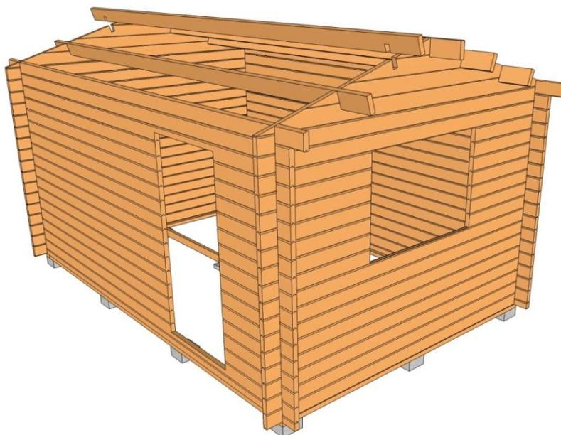
Ett tips när man spikar taket är att ta en takfotsbräda och fästa den med ena långsidan mot centrum pånocken. Då kan man styra takbrädorna mot denna när man spikar taket. Stick ut brädorna drygt 30cm utanför sidoväggen. Tillkapning av takbrädorna sker efter montering.
